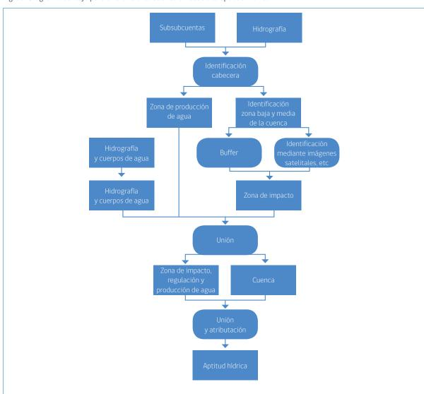
Fig. 39. Diagrama de flujo para diferenciar la cuenca en base a la aptitud hídrica
