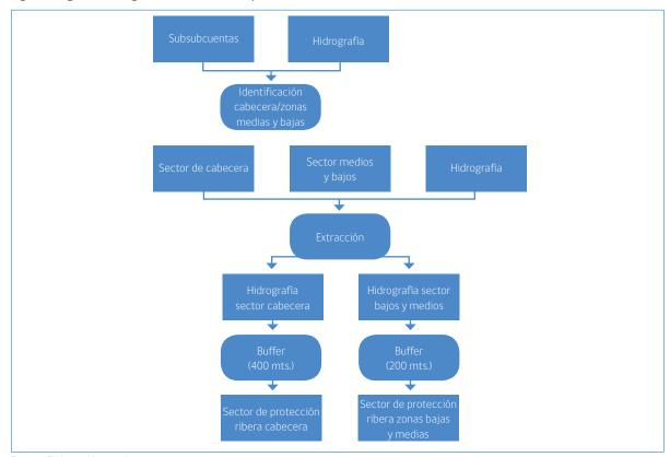
Fig. 40. Diagrama de la generación de zona de protección de cauces
